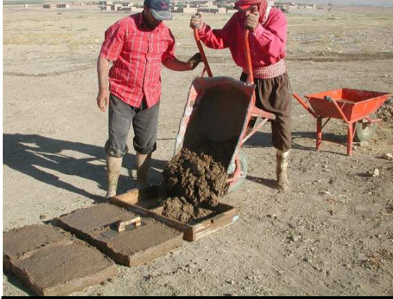
صناعة اللبن (الطوب المجفف) الحديثة في تل موزان
